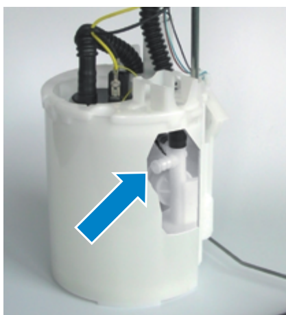
Abb. 1: Blick in das Kraftstofffördermodul (Aufriss) mit Blindanschluss
